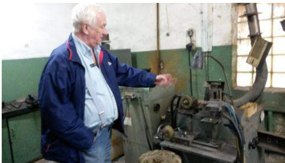
Н. В. Бурносов возле электроконтактной установки для напайки пластин на зубья дисковых пил (г. Молодечно, ОАО «Молодечномобель»)
